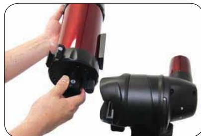
**9** Вставьте крепежную планку оптической трубы в зажим вилочной монтировки, как показано на рисунке выше, при этом надпись на трубе не должна быть перевернута.
