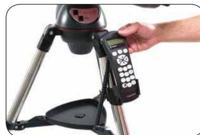
**15** Установите пульт управления в держатель. Пульт управления оснащен кабелем с разъемом телефонного типа.
