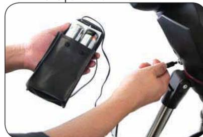
**18** Воткните разъем батарейного блока в 12В гнездо питания на основании телескопа.
