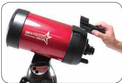
**11** Вставьте крепление искателя в платформу типа «ласточкин хвост». Расположите искатель так, чтобы его стеклянное окно было обращено к передней части трубы. Закрепите крепление искателя фиксирующими винтами.
