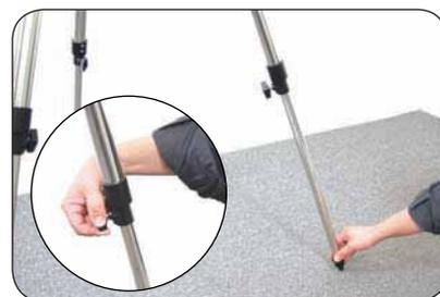
**3** Опоры штатива выдвигаются на желаемую длину, регулируя высоту монтировки. Для этого ослабьте зажим винта фиксатора на каждой опоре, выдвиньте опоры на желаемую высоту.
