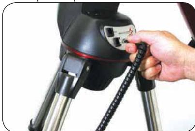
**16** Вставьте его в гнездо порта "Hand Control", расположенное в основании монтировки телескопа.
