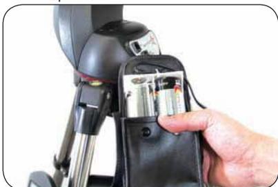
**17** Для питания телескопа: Вставьте восемь батарей типа «D» в батарейный блок.
