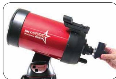
**12** Ослабьте винты фиксаторов окулярного адаптера, а так же снимите крышку с адаптера. Установите диагональное зеркало и зафиксируйте его винтом.
