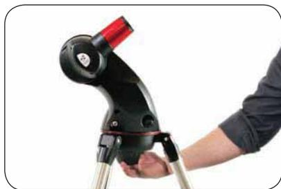
**8** Закрутите зажимной винт в отверстие в нижней части основания монтировки и затените его вручную.
