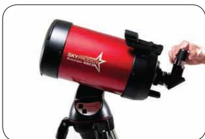
**13** Вставьте хромированную посадочную втулку окуляра в диагональное зеркало и закрепите окуляр винтом фиксатором.
